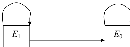
Рис. 3.5. Граф состояний: E_0 – неработоспособное; E_1 – работоспособное состояние
